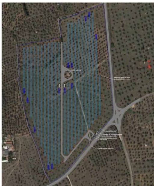
Figura 18 - layout dell'impianto fotovoltaico
